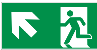
Rettingsweg links aufwärts (ASR A1.3)
