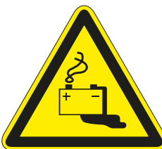
Warnung vor Gefahren durch das Aufladen von Batterien (ASR A1.3)
