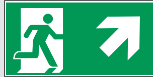
Rettungsweg rechts aufwärts gehen (ASR A1.3)
