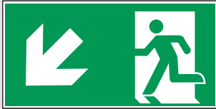
Rettungsweg links abwärts gehen (ASR A1.3)
